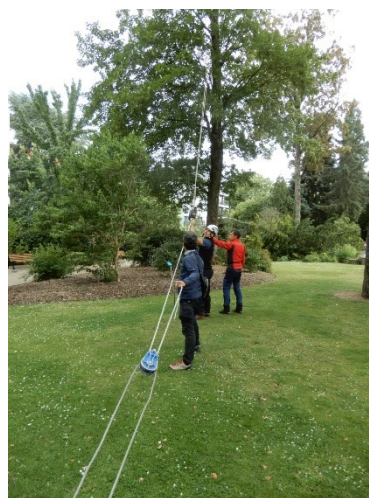
写真4 載荷装置により引っ張加重を掛ける
