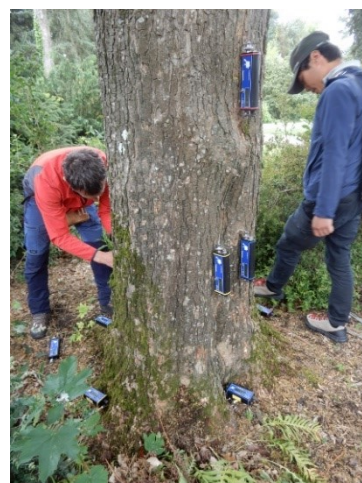
写真3 Tree Qinetic 各センサーの設置
