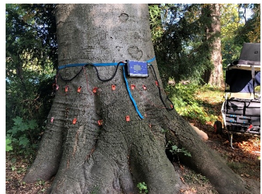
写真1 電気抵抗断層撮影装置 (PiCUS Tree Tronic) による診断状況
