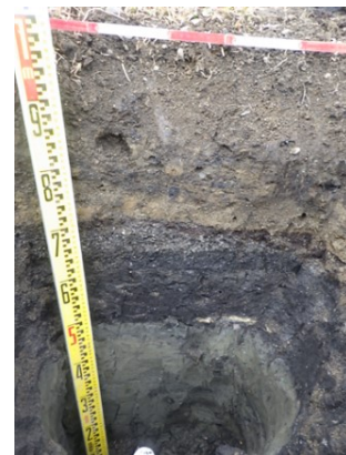
写真. 1 海底土砂吹上埋め立て地土壌断面事例
