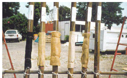
写真8 幹巻材試験(左から①⇒⑥の順)
